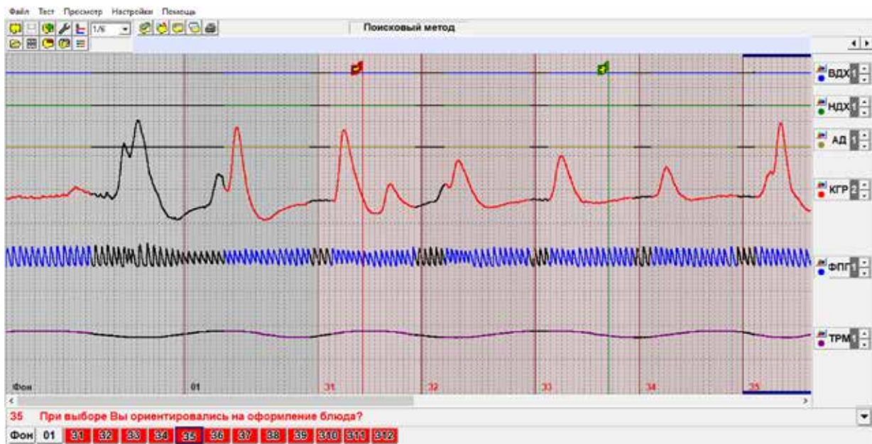
Fig. 15. Polygram with GSR and PPG signals Рис. 15. Полиграмма с ритмами КГР и ФПГ
